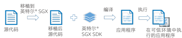
图 2-5-10 应用程序与英特尔® SGX 技术的集成
